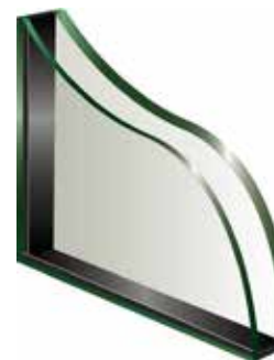
DOUBLE VITRAGE 6/18/4* Warm edge de série Technologie PLANITHERM® Ug = 1,1 W/(m².K) DOUBLE VITRAGE 6/14/4** Warm edge de série
